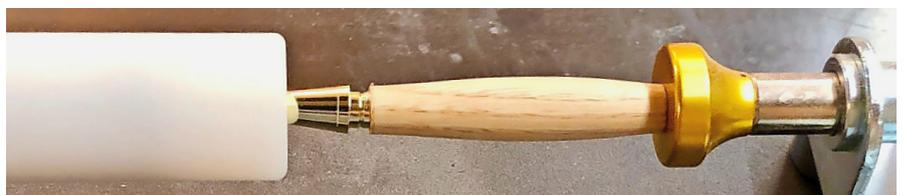
Eine Hebelpresse drückt die fast fertige Kugelschreiberhülle zusammen.
